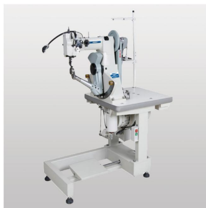
JK168 双线内线机 Double inner line machine
