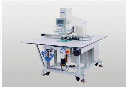
JK8400A-6055H 全自动模板机 Automatic pattern template sewing machine (600x550mm)
