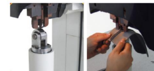
JK-298-B 电脑上胶折边机 Auto hot-cement edge folding machine
