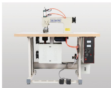
JK-U60-2S-Q 超声波花边机 Ultrasonic welding machine
